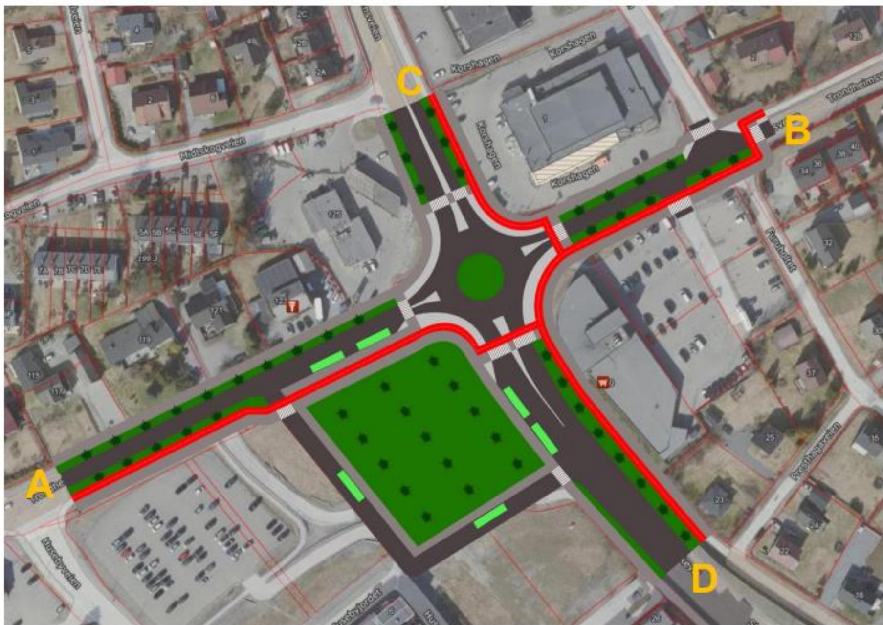
Figur 4.3: Figuren viser i prinsippsskisse hvordan veinettet tenkes omformet til gatestruktur med bredt fortau, trekker og separat gang- og sykkelvei (rødt). Skissen viser også kollektivterminal (busser vist med lys grønt).
